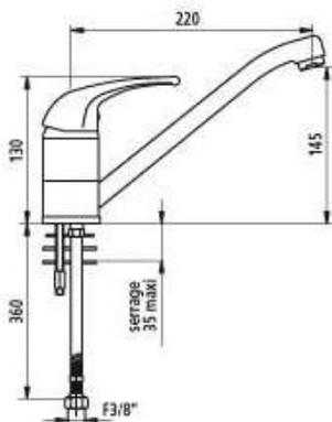
Mitigeur à bec orientable H.145 L.220 avec commande par manette ajourée. Bec en laiton chromé avec brise-jet hygiénique (sans rétention d'impuretés et résistance aux chocs thermiques).
